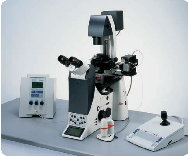
Arbeitsplatz mit PatchMan NP 2 und FemtoJet® hier gezeigt am Leica® DMI6000 B
