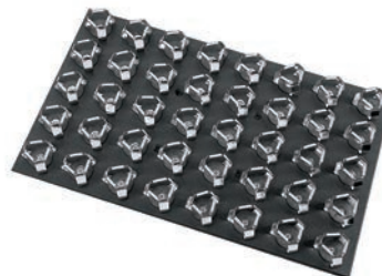
Universalplattform mit Halteklammern, Reagenzglasgestellen und Haftband.
