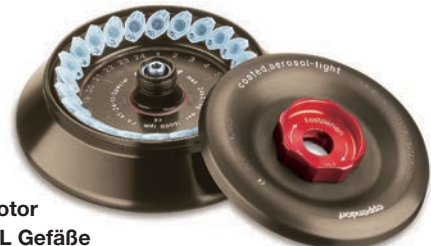
Aerosoldichter Rotor für 24 x 1,5/2,0 mL Gefäße. (FA-45-24-11)
