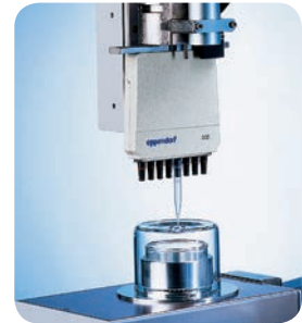
Kalibrierung des Dosierwerkzeugs (gravimetrisch), des Thermomoduls und der Vakuumkammer
