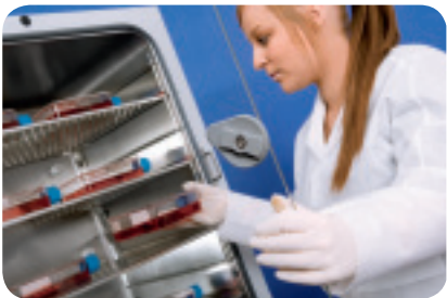
Die abgedichtete Innentür aus Glas, die bei 170-L-Modellen serienmäßig ist, gibt freie Sicht auf die Proben, ohne diese durch Türöffnen zu beeinträchtigen
