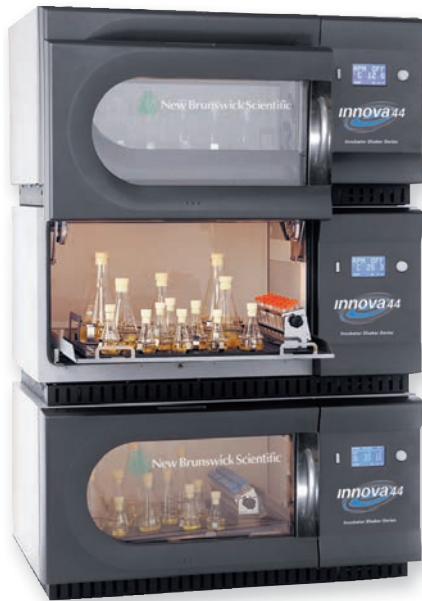
Abgebildet sind 3 Schüttler mit dem serienmäßigen Ausziehmechanismus
